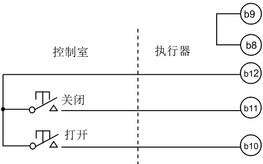
图 4-2 保持式打开/关闭控制，行程可逆，但不能停在中途位置
